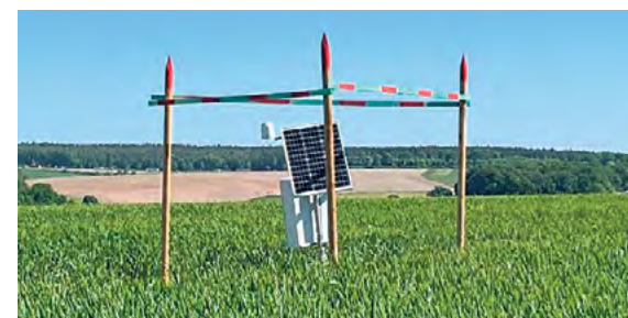
Beispiel für eine Bodenfeuchtemessstation: Das Foto zeigt den Messplatz in Eineborn im Südosten des Saale-Holzland-Kreises.
